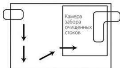
Вариант жиросъемщика без установки дополнительной камеры для сбора крупного мусора
