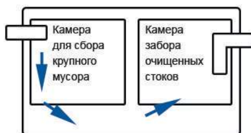
Внутреннее устройство пескоуловителя
