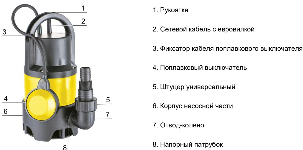
4.2. Однофазный асинхронный электродвигатель с короткозамкнутым ротором размещен в закрытом от попадания жидкости кожухе. Также в кожухе насоса расположен пусковой конденсатор. Специальная теплообменная камера электродвигателя, контактирующая с перекачиваемой водой, обеспечивает его надежное охлаждение при правильной эксплуатации насоса.
