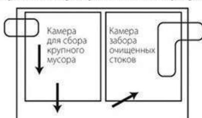
Вариант жиросъемщика с дополнительной камерой для сбора крупного мусора
