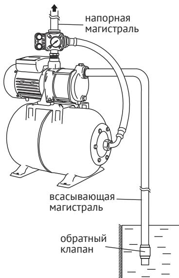
Присоедините всасывающую трубу с обратным клапаном на конце к входному отверстию насоса (7).
