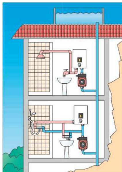
Если насос установлен в трубе в которой может скапливаться воздух, то к нему нужно установить автоматический воздухоотводчик.
