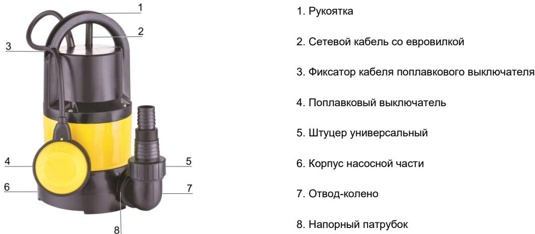
4.2. Однофазный асинхронный электродвигатель с короткозамкнутым ротором размещен в закрытом от попадания жидкости кожухе. Также в кожухе насоса расположен пусковой конденсатор. Специальная теплообменная камера электродвигателя, контактирующая с перекачиваемой водой, обеспечивает его надежное охлаждение при правильной эксплуатации насоса.
