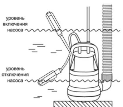
3.5.2. При эксплуатации насоса в вертикальном положении или в положении под наклоном, включать его в сеть допускается только, если его насосная часть погружена в воду не менее, чем на 10 см.
