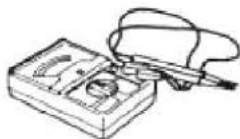
Вольтметр переменного тока (тестер)
