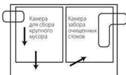
Вариант жироуловителя с дополнительной камерой для сбора крупного мусора
