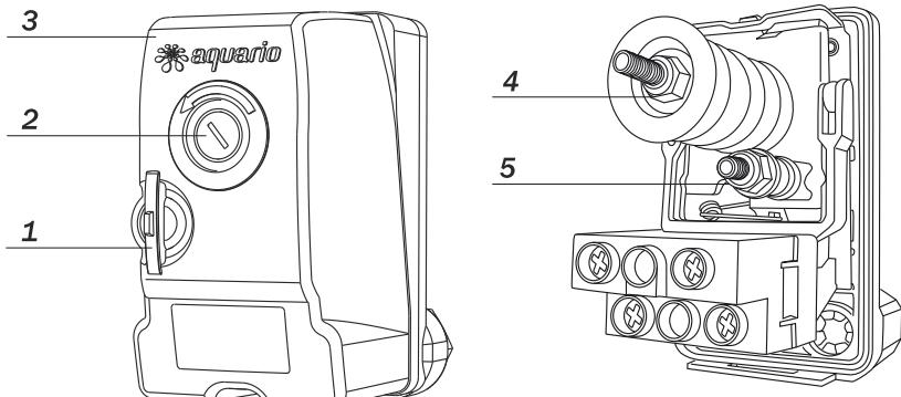
2. Вращением гайки(4) одновременно регулируется давление пуска (нижняя настройка) и давление отключения (верхняя настройка). Вращение по часовой стрелке одновременно увеличивает обе настройки, вращение против часовой стрелки – уменьшает.
