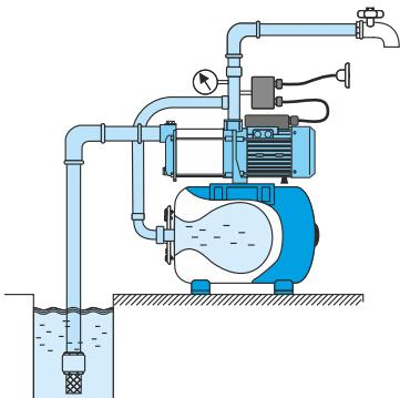
**Рис.13** Когда давление воды в системе достигает определенного значения - **давления отключения**, реле выключает насос.
